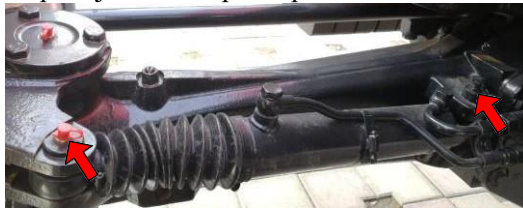
Obrázek 5-11 Údržba hydraulického válce řízení
